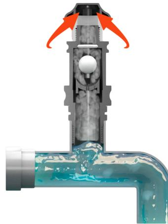
**Phase de drainage** des fluides et introduction d'air dans le système.
