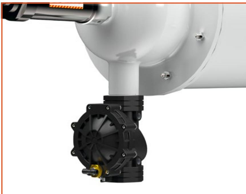
Para el montaje de la válvula, se recomienda la aplicación de cinta de teflón o algún tipo de sellante en la rosca de la toma de drenaje de la tapa del filtro con la finalidad de evitar fugas.
