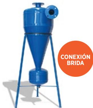
El **Hidrociclón** permite separar la arena y otras partículas más pesadas del agua. Como consecuencia de la fuerza centrífuga, las partículas sólidas se desplazan hacia la pared del cono, con una trayectoria espiral descendente por la fuerza de gravedad, hasta
