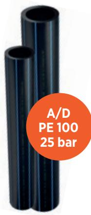
\*Barras 6 y 12 metros. Tubería fabricada en PE100 bajo la normativa UNE-EN 12201-2. Disponemos de tubería banda morada para agua regenerada y con banda marrón para agua residual. Para otras medidas de 20 o 25 bares, consultar.
